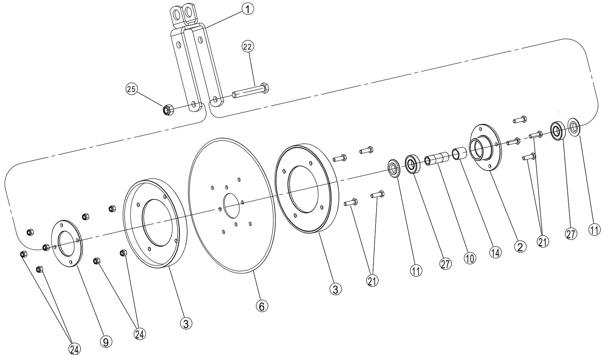
Схема установки окучника на секцию
